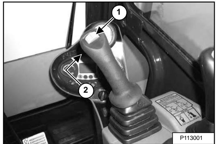
Передвиньте переключатель (элемент 1) [Рис. 56] на правом рычаге управления вправо, чтобы активировать подачу гидравлического потока к гнездовому соединителю. Передвиньте переключатель влево, чтобы подать гидравлический поток на штыревой соединитель. Если сдвинуть переключатель наполовину, то функции вспомогательной гидравлики будут работать приблизительно на вдвое меньшей скорости.
