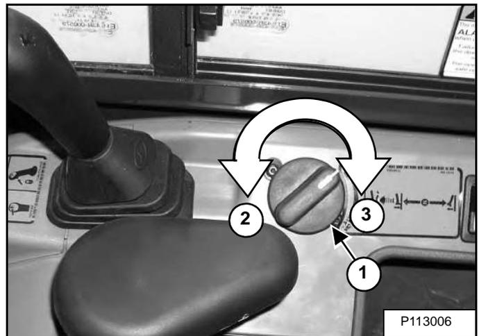
Ручка управления оборотами двигателя (элемент 1) [Рис. 66] позволяет управлять скоростью двигателя.
