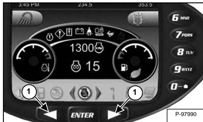
Остановите двигатель и поверните ключ зажигания в положение ON (ВКЛ.). Нажмите любую кнопку прокрутки (элемент 1) [Рис. 58] (приборная панель Deluxe), пока не отобразится вышеприведенный экран.
