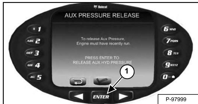
Нажмите кнопку ENTER (Ввод) (элемент 1) [Рис. 59], чтобы стравить давление во вспомогательной гидравлической системе экскаватора. На экране появится значок песчаных часов, а при стравливании давления появится сообщение *Auxiliary Hydraulic Pressure Release* (Стравливание давления во вспомогательной гидравлической системе).
