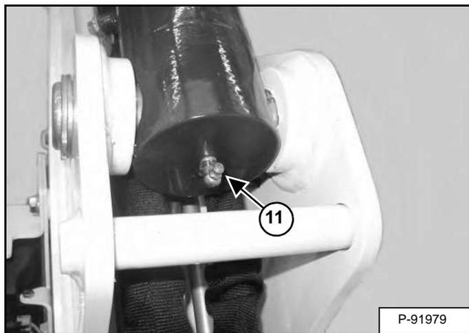
11. Конец лапы цилиндра рычага (1) [Рис. 273]
