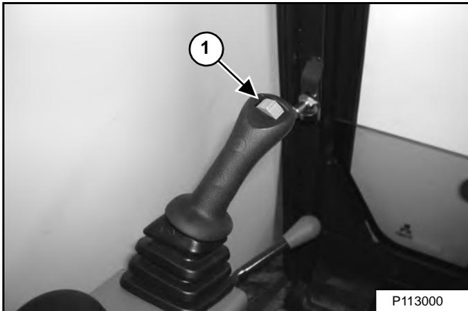
Передвиньте переключатель (элемент 1) [Рис. 61] на левом рычаге управления влево, чтобы активировать подачу гидравлического потока к гнездовому соединителю. Передвиньте переключатель вправо, чтобы подать гидравлический поток на штыревой соединитель. Если сдвинуть переключатель наполовину, то функции вспомогательной гидравлики будут работать приблизительно на вдвое меньшей скорости.
