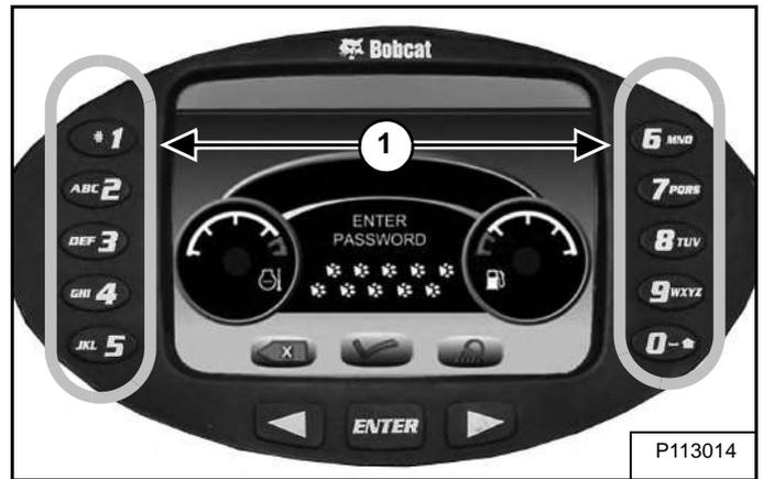
Поверните ключ (элемент 2) [Рис. 90] в положение ON (ВКЛ.). Сообщение *ENTER PASSWORD* (ВВЕДИТЕ ПАРОЛЬ) будет отображаться на экране, если приборная панель Deluxe заблокирована. (Если блокировка отсутствует, не требуется вводить пароль для запуска двигателя ключом.)
