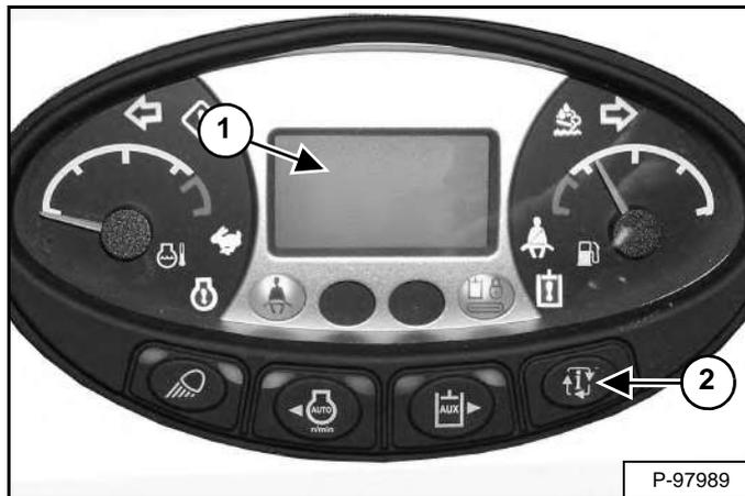
Нажмите информационную кнопку (элемент 2), чтобы просмотреть экраны (элемент 1) [Рис. 280] и вывести экран со служебным кодом. Если служебных кодов несколько, то они будут отображаться на дисплее данных один за другим.
