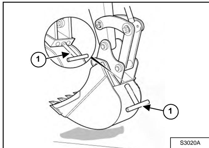
Установите ключ (элемент 1) [Рис. 102] на стопорные штыри и поверните против часовой стрелки до их извлечения.
