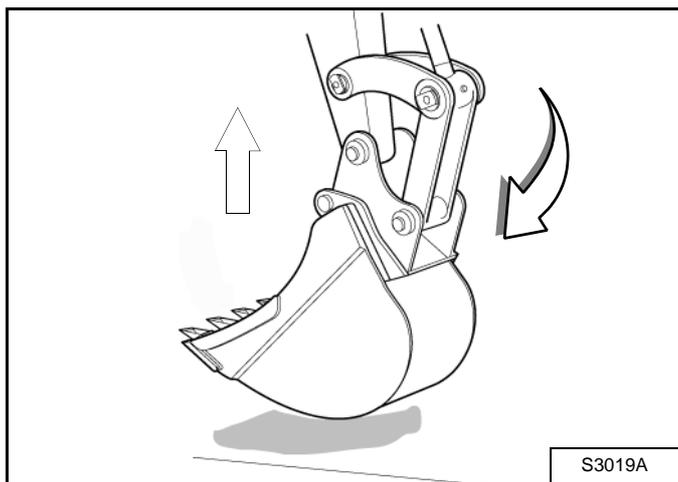
Поднимите стрелу и выдвигайте цилиндр ковша до тех пор, пока навесное оборудование не окажется немного над землей [Рис. 101].
