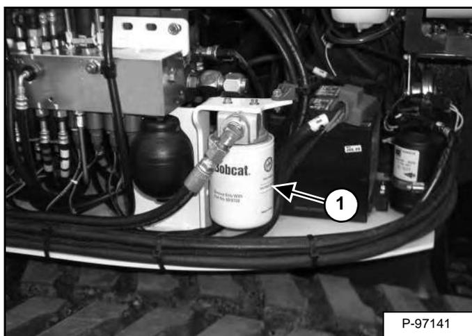
Снимите сливной фильтр картера (элемент 1) [Рис. 244].
