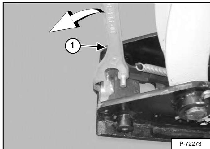
Для открытия устройства быстрого соединения установите инструмент (элемент 1) [Рис. 107] и потяните ручку. Фиксатор переместится вперед полностью. Фиксатор заблокирует положение открытия.
