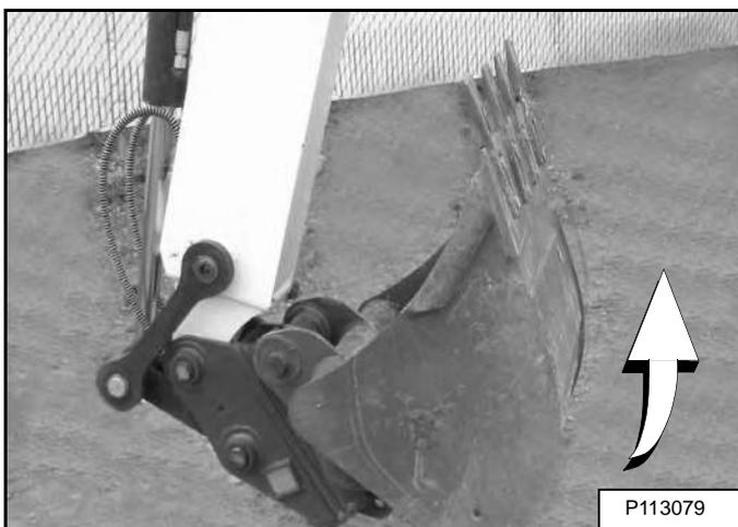
Переведите правый джойстик (элемент 1) [Рис. 137] влево (ВНУТРЬ) и полностью сложите устройство быстрого соединения (элемент 1) [Рис. 138].
