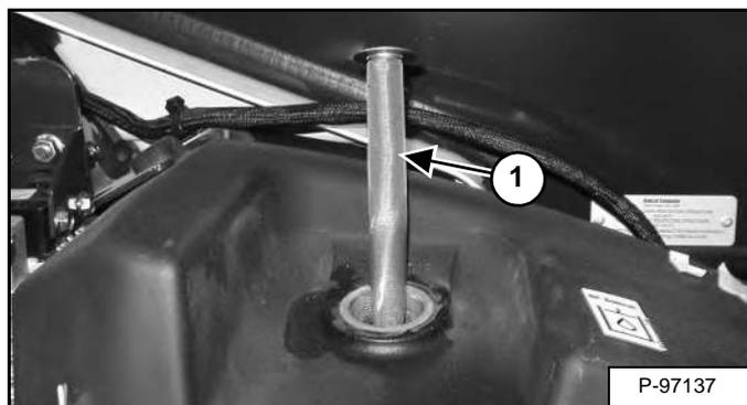
Проверьте состояние наполнения сеточного фильтра (элемент 1) [Рис. 240]. При необходимости очистите или замените.
