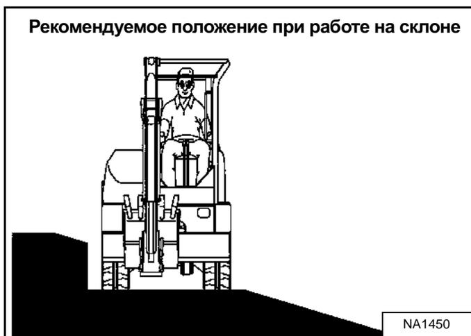
Перед началом работ на склоне разровняйте рабочую площадку [Рис. 176].
