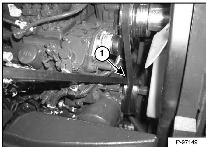
Установите рычаг между ремнем и шкивом коленвала (элемент 1) [Рис. 259].
