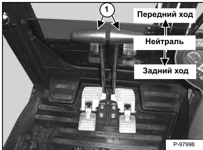
Чтобы затормозить во время спуска, передвиньте рулевые колонки (элемент 1) [Рис. 177] в **НЕЙТРАЛЬ-НОЕ** положение. Включится гидростатический тормоз.
