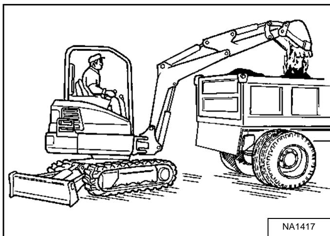
Выдвиньте рукоять и разгрузите ковш на кучу или в кузов грузовика [Рис. 164].
