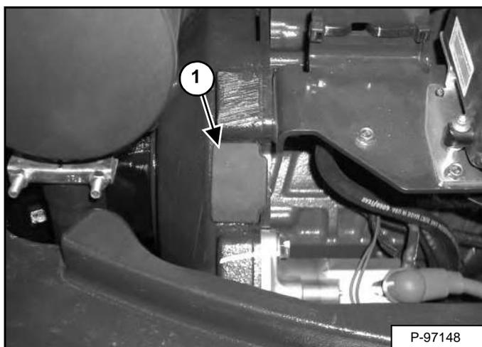
Для снятия ремня необходимо поворачивать двигатель вручную. Для доступа к маховику снимите заглушку (элемент 1) [Рис. 262] с корпуса маховика.
