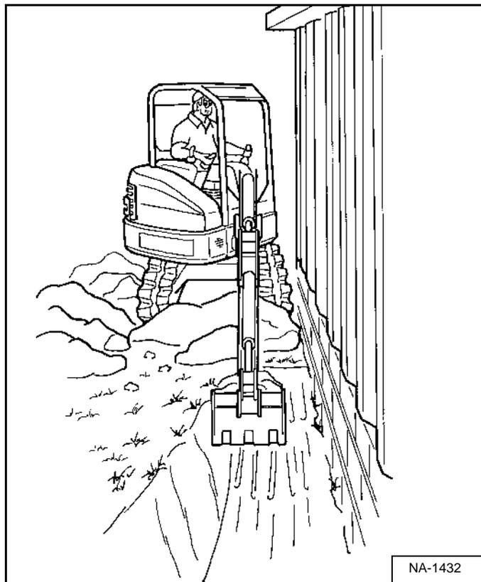
**ПРИМЕЧАНИЕ.** Поворот стрелы используется для смещения стрелы относительно поворотной платформы при выполнении копательных работ близко к строениям [Рис. 68].
