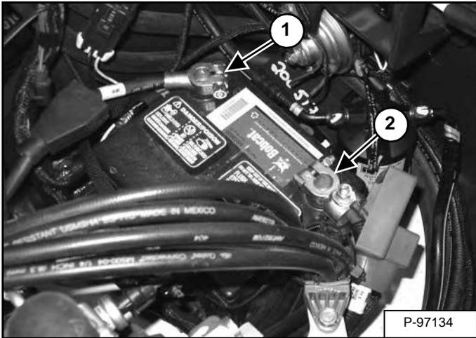
Сначала отключите отрицательный (-) кабель (элемент 1) [Рис. 237].
