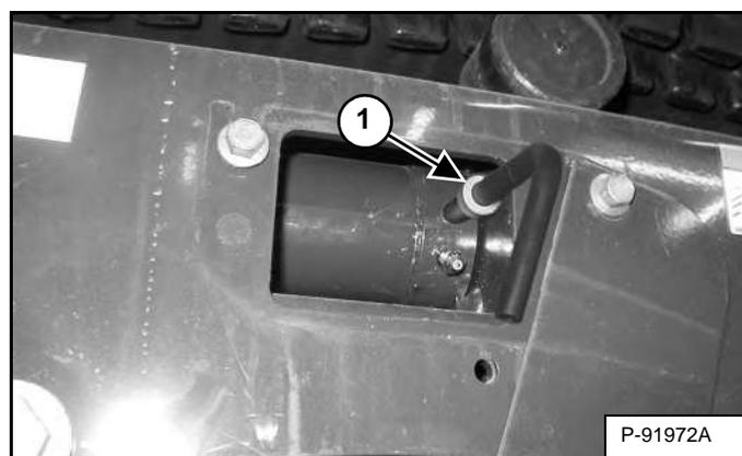
Используйте инструмент MEL1560 (элемент 1) [Рис. 255], чтобы ослабить прокачной штуцер (элемент 2) [Рис. 254] (максимум на 1 1/2 оборота) для уменьшения натяжения полотна.
