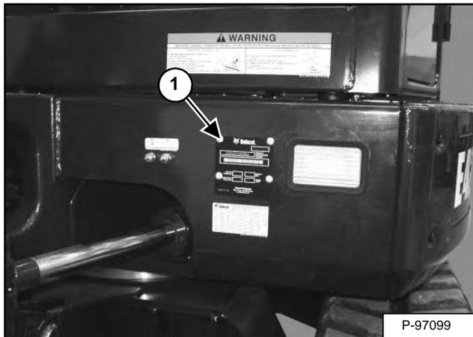
Серийный номер экскаватора (элемент 1) [Рис. 1] расположен на корпусе машины в указанном месте.
