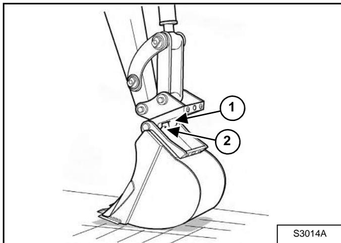
Вставьте крюки устройства соединения (элемент 1) в гнездо навесного оборудования (элемент 2) [Рис. 98].
