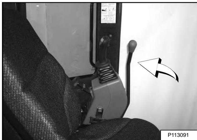
Когда левая консоль поднята [Рис. 189], система сцепления и гидравлические рычаги управления (джойстики) не должны работать.
