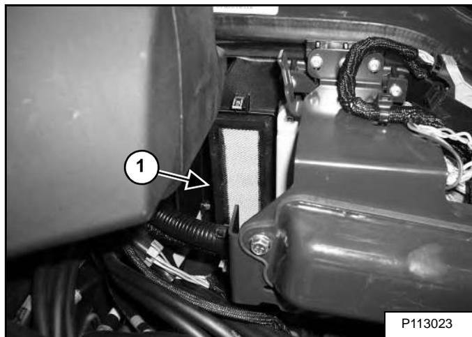
Извлеките фильтр (элемент 1) [Рис. 203] из обогревателя.
