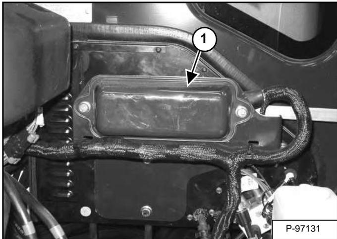
Экскаватор оборудован электрической системой с отрицательным заземлением и напряжением 12 В. Электрическая система защищена предохранителями (элемент 1) [Рис. 231], которые находятся под правой крышкой экскаватора. Предохранители защищают электрическую систему при возникновении электрической перегрузки. Перед повторным запуском двигателя необходимо обнаружить и устранить причину возникновения перегрузки.
