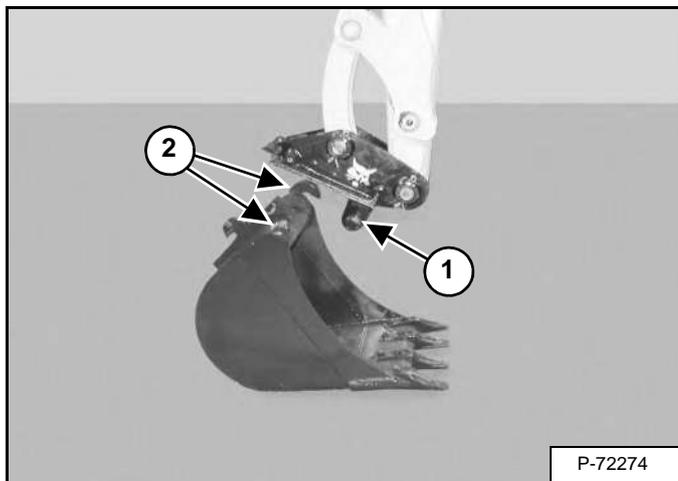
Проверяйте устройство быстрого соединения на отсутствие износа или повреждений. Проверьте штыри устройства быстрого соединения (элемент 1) и крюки (элемент 2) [Рис. 265] (на навесном оборудовании) на отсутствие износа или повреждений.
