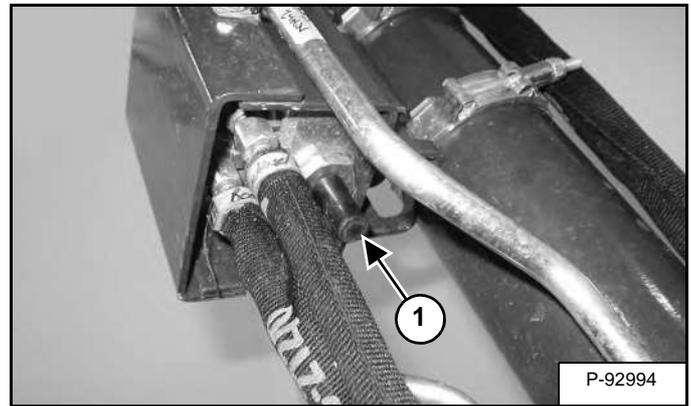
Снимите пластиковую защитную крышку (элемент 1) [Рис. 70] с клапана.
