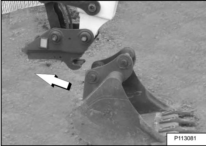
Полностью сложите устройство быстрого соединения назад.
