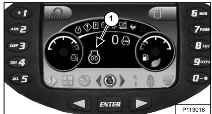
Если необходим предварительный нагрев, запальные свечи включатся автоматически, а на информационном дисплее будет отображаться значок предварительного нагрева (элемент 1) [Рис. 92].
