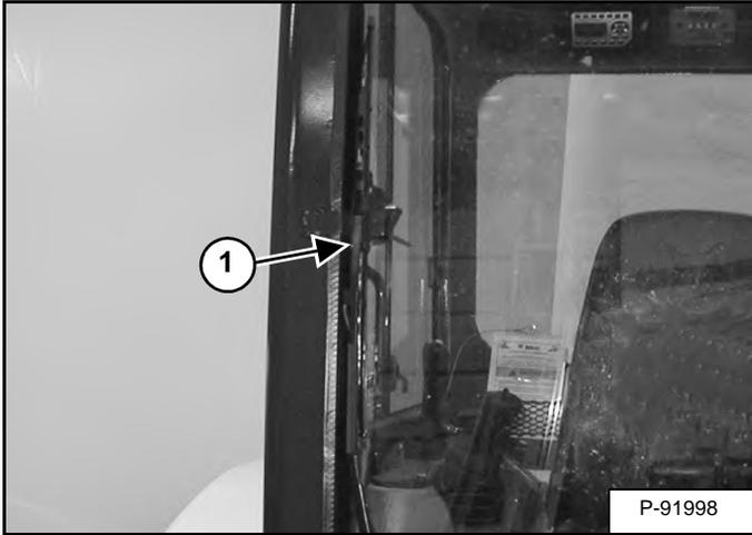
Переднее окно оснащено стеклоочистителем (элемент 1) [Рис. 29] и стеклоомывателем.
