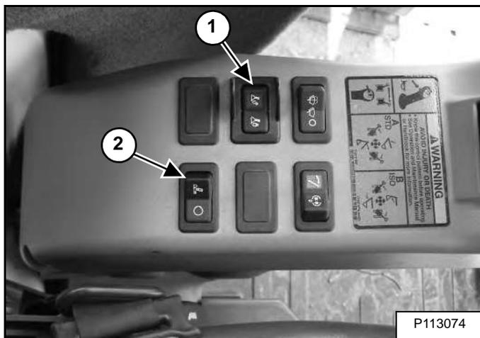
Переведите переключатель устройства соединения (элемент 1) [Рис. 132] в левое положение (ВКЛ.), чтобы включить функцию быстрого соединения типа Pin Grabber. При включении переключателя загорится его индикатор, и прозвучит сигнал.
