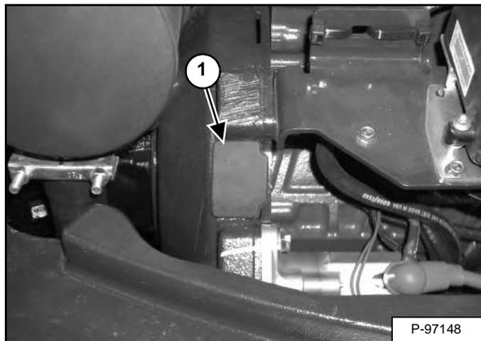
Для снятия ремня необходимо поворачивать двигатель вручную. Для доступа к маховику снимите заглушку (элемент 1) [Рис. 258] с корпуса маховика. (Для снятия ремня и его установки потребуется рычаг для вращения маховика.)
