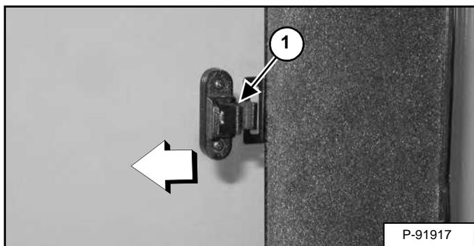
Вытяните фиксатор (элемент 1) [Рис. 32].
