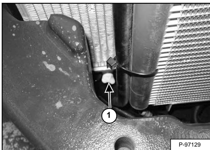
Наденьте шланг на дренажный клапан в днище радиатора. Откройте сливной клапан (элемент 1) [Рис. 229] и слейте охлаждающую жидкость в контейнер.
