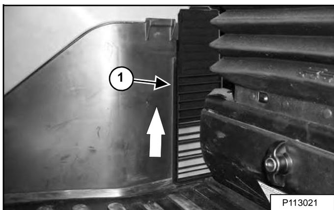
Потяните фильтр (элемент 1) [Рис. 201] до извлечения из корпуса.
