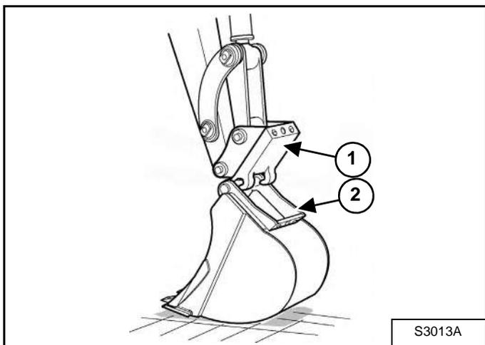
Опустите устройство соединения (элемент 1) на навесное оборудование (элемент 2) [Рис. 97].
