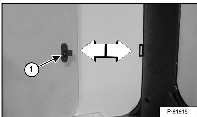
Чтобы открыть окно, переместите фиксатор (элемент 1) [Рис. 33] вперед. Когда окно открыто, надавите на фиксатор (элемент 1) [Рис. 31].
