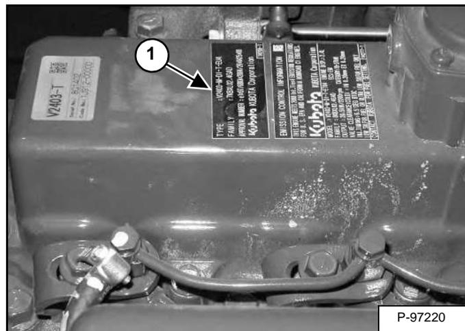
Серийный номер двигателя (элемент 1) [Рис. 3] указан на верхней крышке.
