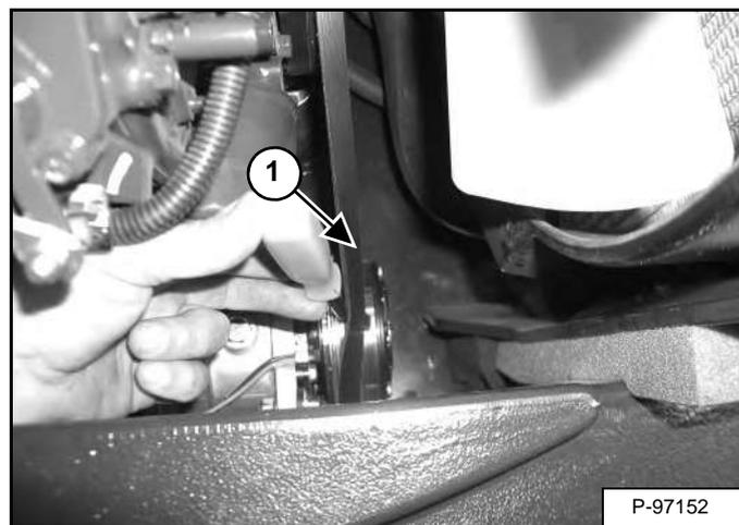
Чтобы снять ремень со шкива, используйте рычаг (элемент 1) [Рис. 263]. Установив рычаг на маховик, вращайте двигатель вручную, чтобы отсоединить ремень от шкива коленвала. Продолжайте вращение маховика, пока ремень не ослабнет. Извлеките ремень.
