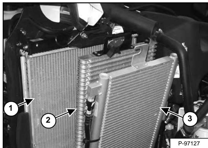
С помощью подаваемого под давлением воздуха или воды очистите радиатор (элемент 1), масляный радиатор (элемент 2) и конденсатор (элемент 3) [Рис. 226] (если имеется). При очистке не повредите ребра радиатора.
