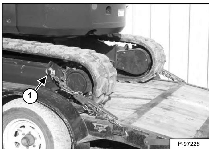
Привяжите цепями передние углы отвала (элемент 1) [Рис. 186] и петли с обеих сторон машины (элемент 1) [Рис. 187], чтобы экскаватор не сдвинулся при подъеме, спуске и резких остановках.
