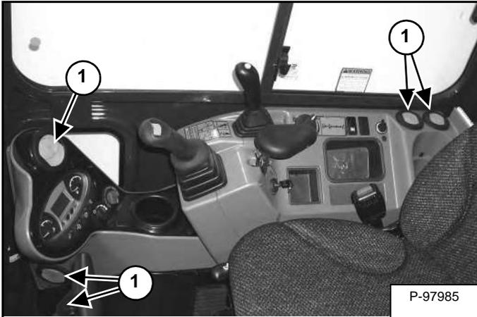
Положение вентиляционных отверстий HVAC (элемент 1) [Рис. 37] можно изменять по мере необходимости, чтобы направлять поток воздуха в различные места кабины.
