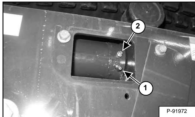
Добавляйте смазку в пресс-масленку (элемент 1) [Рис. 254] до тех пор, пока не будет достигнута необходимая степень натяжения полотна.
