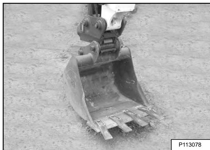
Держа навесное оборудование слегка над землей, сложите устройство быстрого соединения назад, пока оно не начнет отсоединяться от навесного оборудования [Рис. 140].
