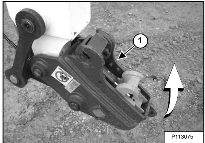
Переведите правый джойстик (элемент 1) [Рис. 130] влево (ВНУТРЬ) и полностью сложите соединение (элемент 1) [Рис. 131] в сторону кабины.
