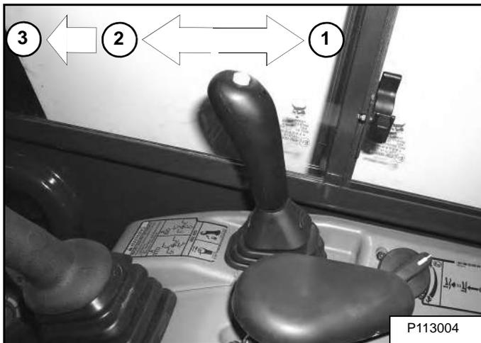
Чтобы поднять отвал (элемент 1), передвиньте рычаг назад [Рис. 65].
