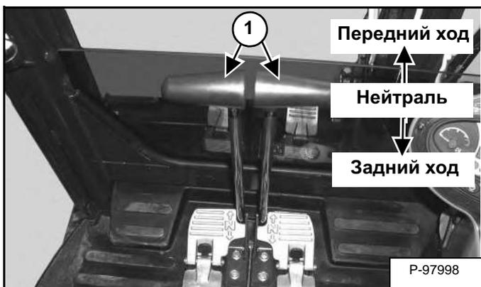
Сдвиньте рычаги управления (элемент 1) [Рис. 84] в нейтральное положение.
