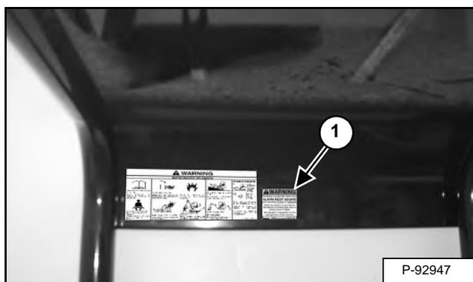
Выполните проверку на предмет поврежденной или отсутствующей наклейки сигнала тревоги при движении (элемент 1) [Рис. 191] (машина с кабиной) или (элемент 1) [Рис. 192] (машина с навесом). При необходимости замените.
