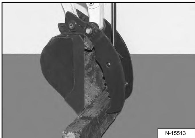
Дополнительное навесное оборудование с подъемным захватом придает экскаватору более широкое применение и мобильность при расчистке завалов [Рис. 158].
