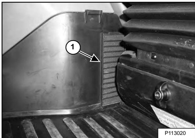
Фильтр рециркуляции (элемент 1) [Рис. 200] расположен справа от кресла оператора.
