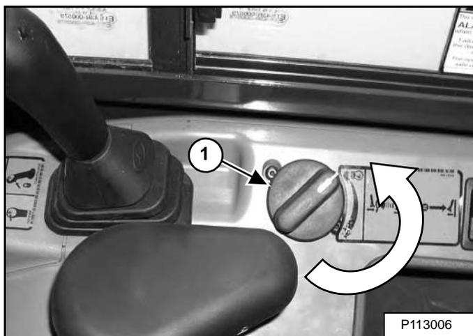
Поверните ручку управления оборотами двигателя (элемент 1) [Рис. 87] в положение низких оборотов холостого хода.
