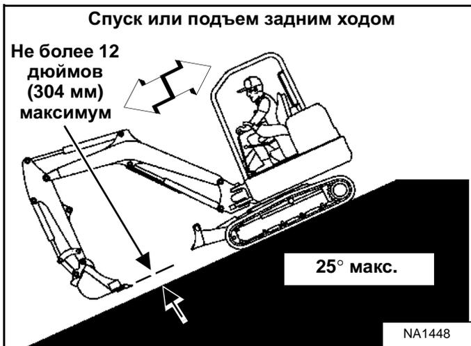
При спуске по поверхностям с уклоном более 15 градусов расположите машину, как показано на рисунке, и передвигайтесь с низкой скоростью [Рис. 173].
