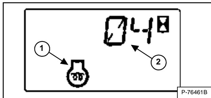
Если требуется предпусковой прогрев, будет автоматически повторяться цикл включения свечей зажигания. Загорится значок предпускового прогрева двигателя (элемент 1), а время, оставшееся до завершения цикла, будет отображаться на дисплее данных (элемент 2) [Рис. 89].
