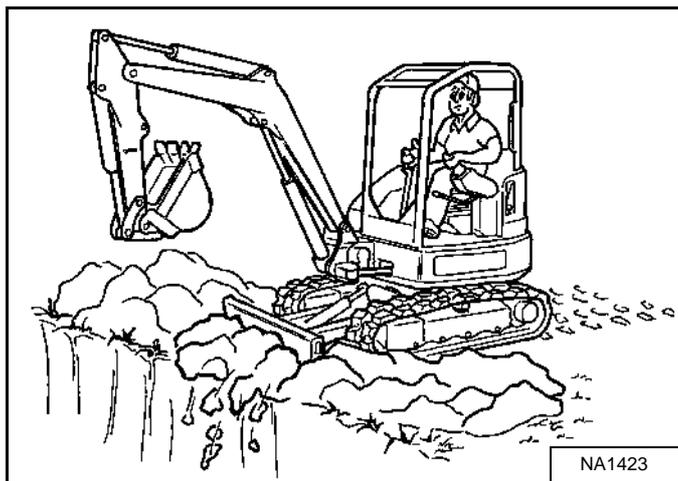
Чтобы засыпать выкопанную траншею или яму, используйте отвал [Рис. 170].
