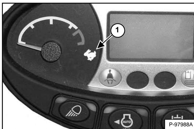
При включении высокой скорости высветится значок двухскоростного привода (элемент 1) [Рис. 19].
