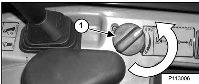
Поверните ручку управления оборотами двигателя (элемент 1) [Рис. 85] против часовой стрелки и установите ее в положение низких оборотов холостого хода.
