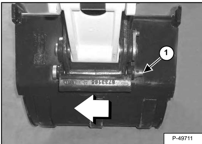
Извлеките штырь (элемент 1) [Рис. 151] из крепежей ковша и системы X-Change.
