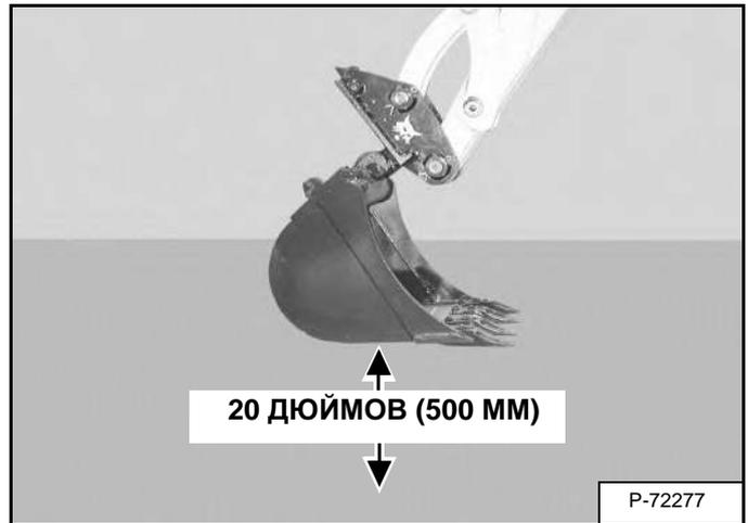
Поднимите стрелу, обеспечив клиренс примерно в 500 мм (20 дюймов) между нижней частью навесного оборудования и землей [Рис. 111].
