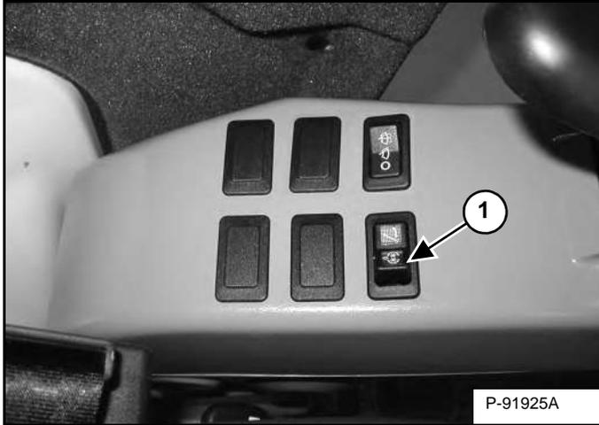
Нажмите кнопку AUX HYD (элемент 1) [Рис. 60] (если имеется) вправо, в положение вторичной вспомогательной гидравлики.
