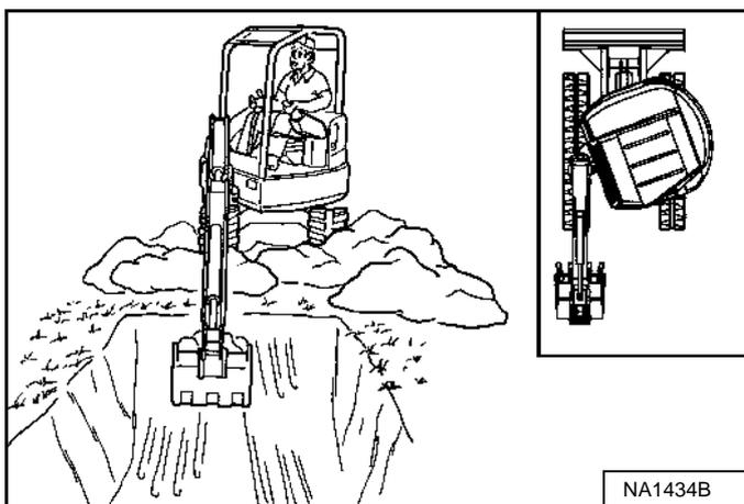
Поворачивая платформу, смещайте стрелу в правую сторону [Рис. 166], в центр [Рис. 167] и в левую сторону [Рис. 168], чтобы, не перемещая экскаватор, выкопать яму квадратной формы, ширина которой равна ширине машины.
