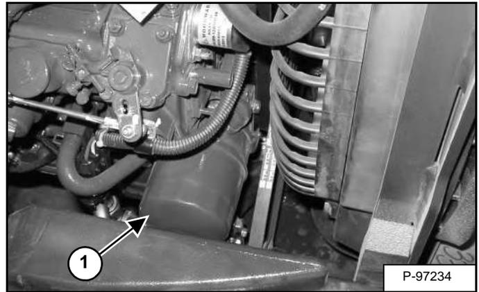
Снимите масляный фильтр (элемент 1) [Рис. 222] и очистите поверхность корпуса фильтра.
