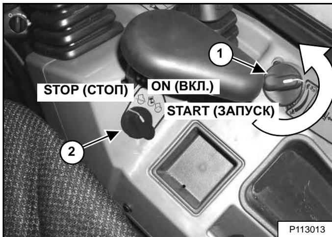
Установите рычаг управления оборотами двигателя (элемент 1) [Рис. 90] в положение низких оборотов холостого хода.
