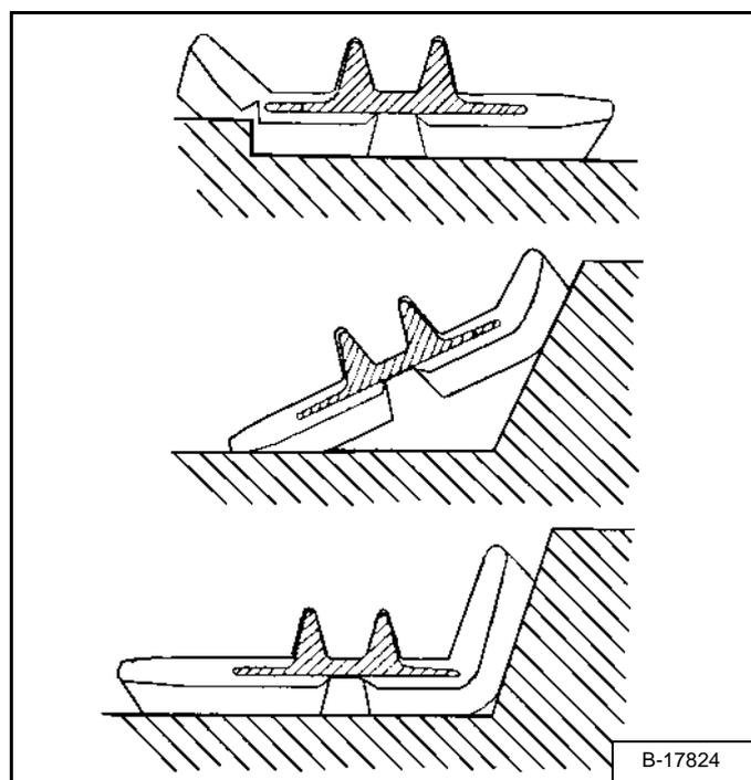
Когда резиновые гусеницы наезжают на острые выступы, резиновая поверхность, обеспечивающая сцепление с грунтом (в особенности те области, где располагаются края внутренних металлических компонентов), подвергается интенсивному воздействию, что приводит к появлению трещин и разрывов в областях внутренних металлических компонентов [Рис. 181].
