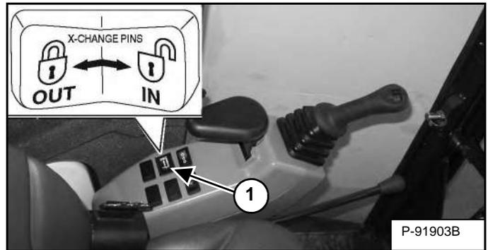
Нажмите и удерживайте переключатель X-Change (элемент 1) [Рис. 123] в левом положении (OUT) и **ПОЛНОСТЬЮ ОТВЕДИТЕ** гидравлические контакты.
