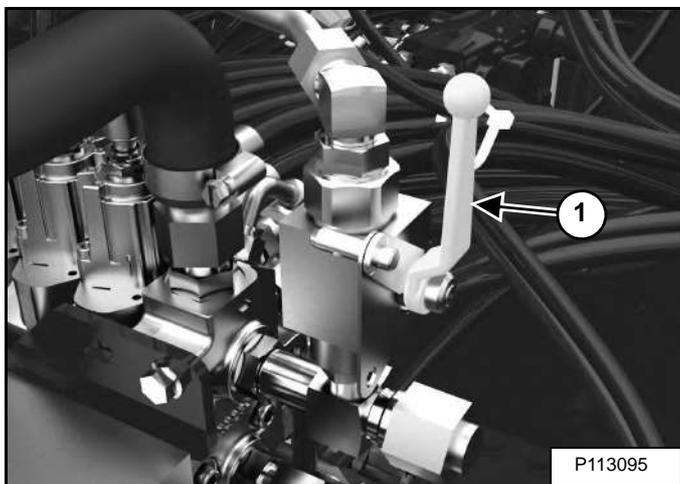
Поверните рычаг (элемент 1) [Рис. 62] по часовой стрелке для возврата рабочей жидкости вспомогательной гидравлики в резервуар.
