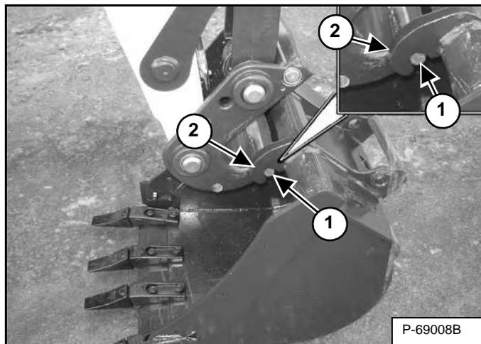
Поднимите стрелу и втяните цилиндр ковша, чтобы контакты системы X-Change (элемент 1) соединились с захватами (элемент 2) [Рис. 127] ковша.
