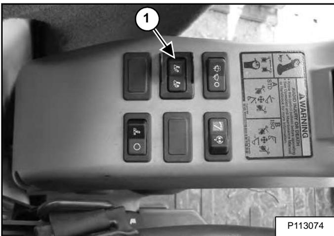
Переведите переключатель устройства соединения (элемент 1) [Рис. 142] в правое положение (ВЫКЛ.). Индикатор переключателя и звуковой сигнал выключатся.
