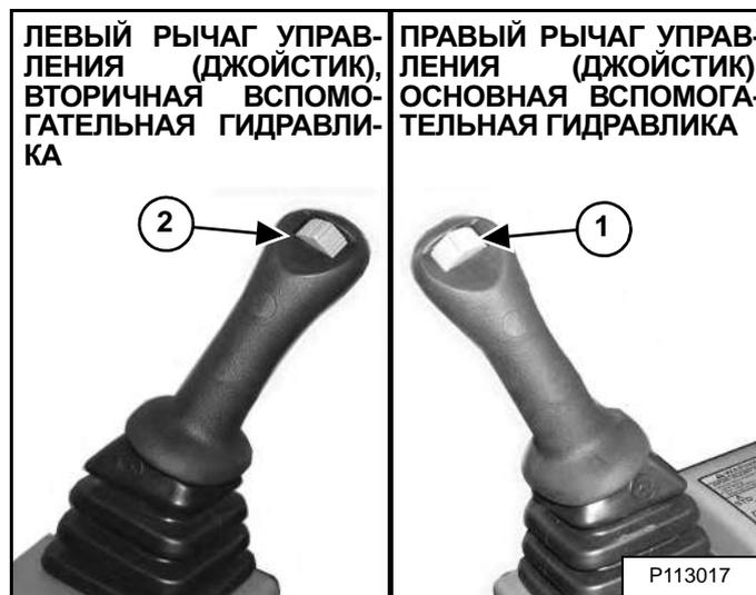
Передвиньте переключатель (элемент 1) [Рис. 159] на правом рычаге управления вправо, чтобы открыть зажим. Передвиньте переключатель влево, чтобы закрыть зажим.
