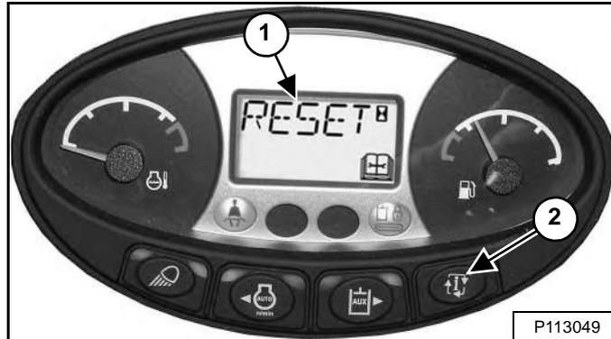
Нажимайте кнопку информации (элемент 2) [Рис. 285], пока на дисплее не появится счетчик часов до обслуживания.
