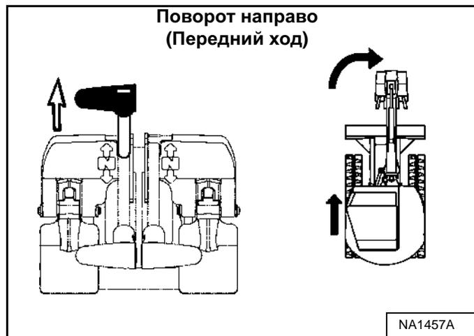
Чтобы повернуть направо [Рис. 43] при движении вперед, передвиньте левый рычаг управления вперед.
