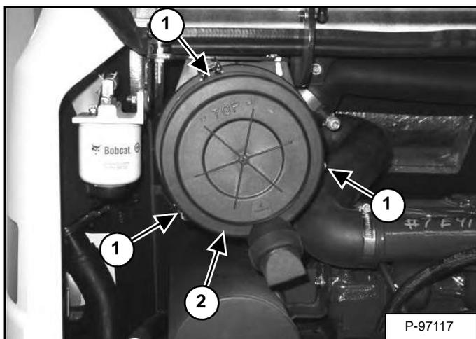
Снимите три фиксатора (элемент 1) [Рис. 208].
