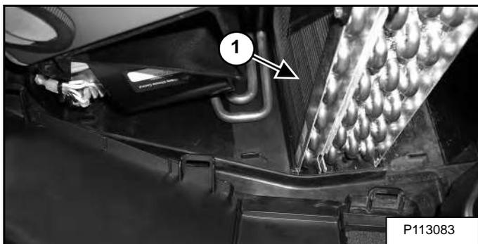
Используйте воздух или воду под низким давлением, чтобы удалить загрязнения и очистить катушки (элемент 1) [Рис. 205].
