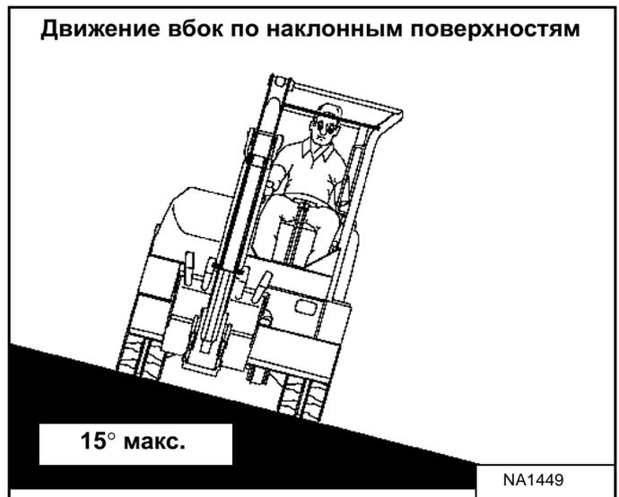
При подъеме или движении вбок по поверхностям с уклоном не более 15 градусов расположите машину, как показано на рисунке, и передвигайтесь с низкой скоростью [Рис. 174] и [Рис. 175].
