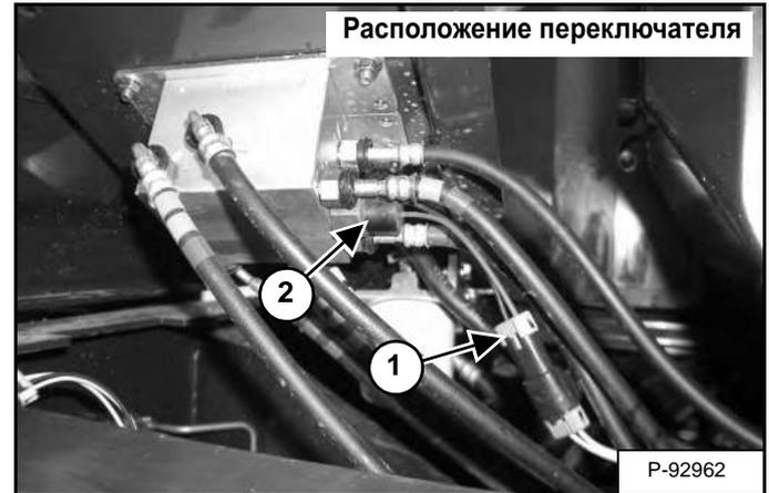
Переключатель сигнала тревоги при движении (элемент 2) [Рис. 195] расположен на клапане управления движением, который находится под пластиной пола. Для доступа к переключателю снимите коврик и пластину пола.
