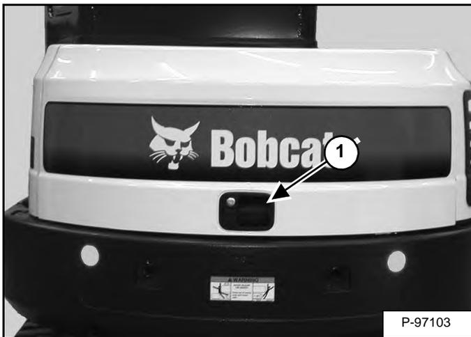
Потяните защелку (элемент 1) [Рис. 196] и откройте заднюю дверь.
