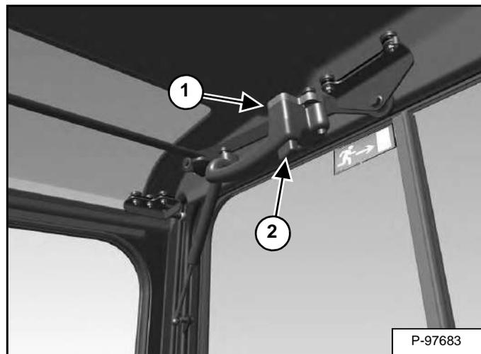
Когда окно будет полностью поднято, фиксатор (элемент 1) [Рис. 28] (с обеих сторон) на кронштейне сработает и перейдет в закрытое положение.
