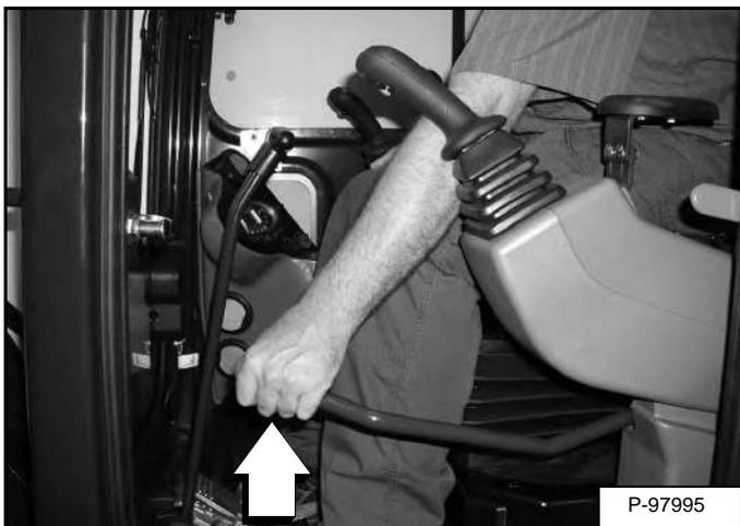
Потяните блокирующий рычаг [Рис. 17]. Поднять консоль поможет подъемная пружина.
