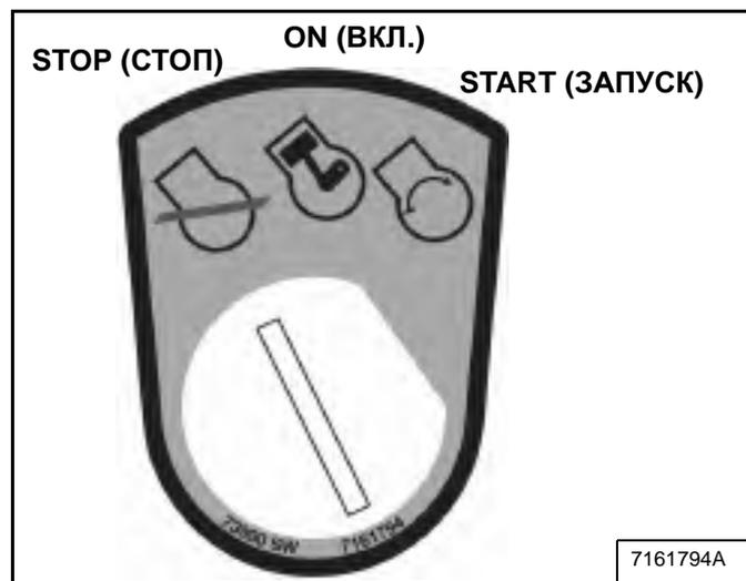
Поверните переключатель в положение STOP (СТОП) [Рис. 96].
