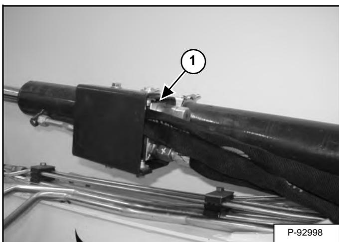
Если экскаватор оснащен клапаном фиксации нагрузки рукояти (элемент 1) [Рис. 72], данный компонент устанавливается на конце лапы цилиндра рукояти, как показано на рисунке.
