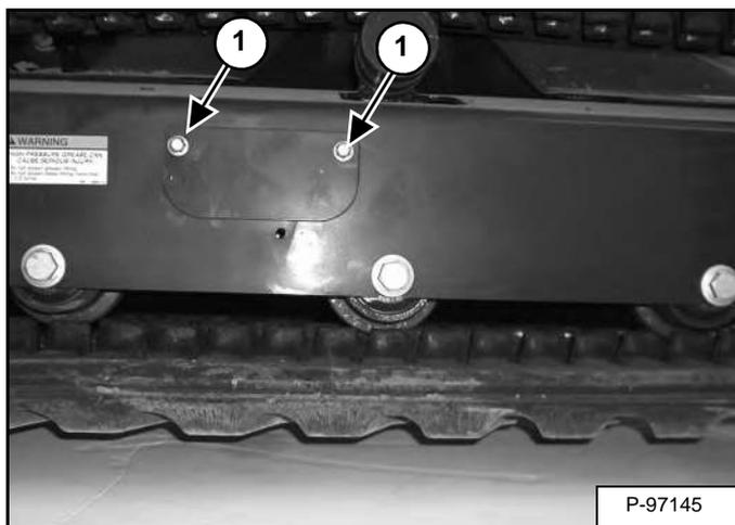
Ослабьте два болта из крышки (элемент 1) [Рис. 253]. Поверните крышку вниз.
