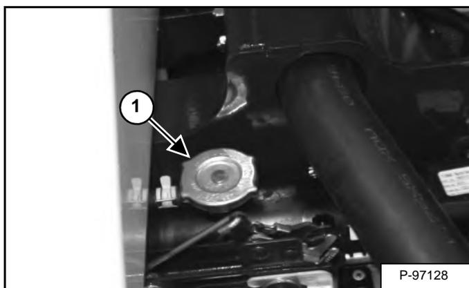
Когда двигатель остынет, выкрутите и снимите крышку радиатора (элемент 1) [Рис. 228].
