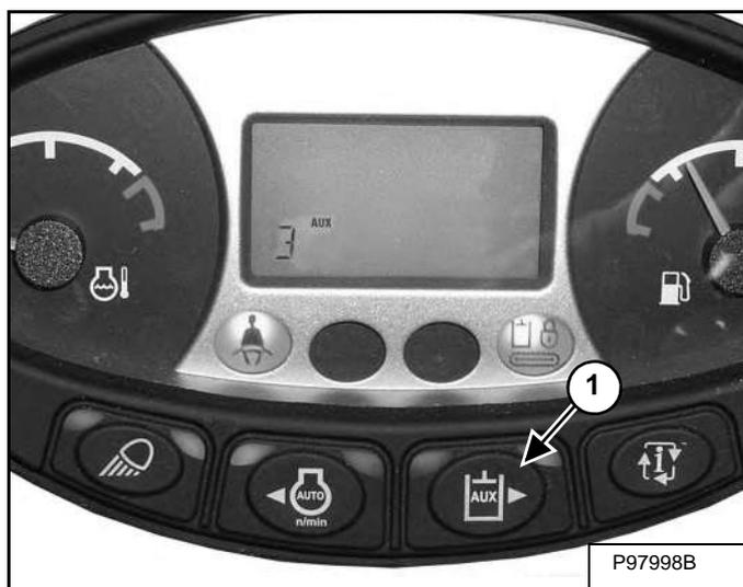
Если вспомогательная гидравлика выключена, нажмите кнопку вспомогательной гидравлики AUX HYD (элемент 1) [Рис. 57] и передвиньте переключатель (элемент 1) [Рис. 56] вправо и влево несколько раз.
