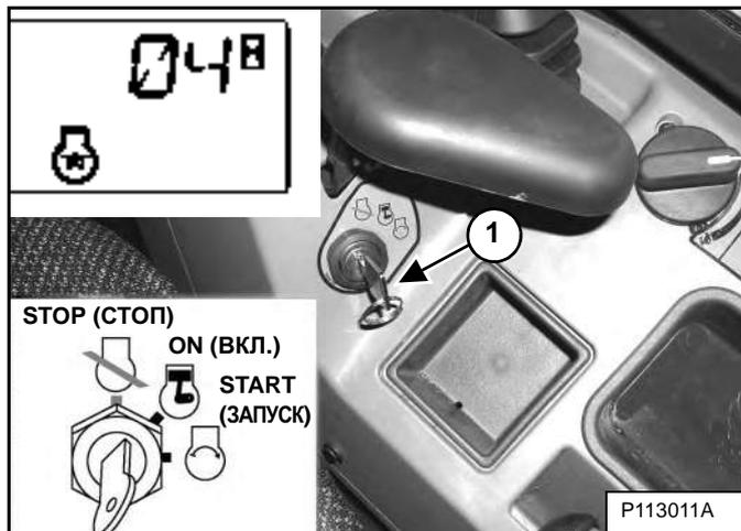
Поверните ключ (элемент 1) [Рис. 86] в позицию ON (ВКЛ.). Если необходим предварительный нагрев, запальные свечи включатся автоматически, и оставшееся время предварительного нагрева (в секундах) будет отображаться на информационном дисплее (см. врезку). (При этом загорится индикатор предпускового подогрева).
