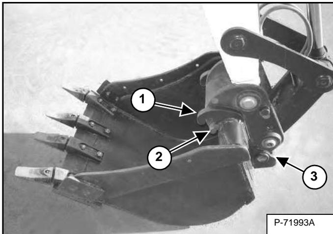
Поднимите стрелу и выдвигайте цилиндр ковша до тех пор, пока система X-Change не соединится с навесным оборудованием [Рис. 122].
