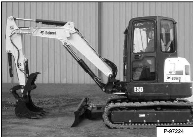
Установите машину на ровной площадке. Опустите рабочее оборудование и отвал на землю [Рис. 94].
