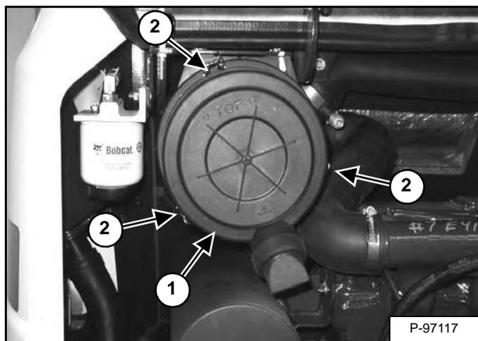
Установите пылезащитный колпачок (элемент 1) и три фиксатора (элемент 2) [Рис. 210].
