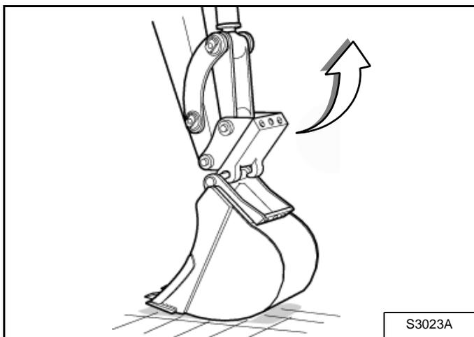
Вытащите рукоять и поднимите стрелу до полного разъединения устройства быстрого соединения и навесного оборудования [Рис. 105].
