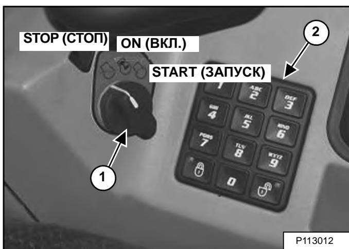
Поверните ключ (элемент 1) [Рис. 88] в положение ON (ВКЛ.). Индикаторы на приборной панели загорятся на короткое время, и приборная панель/система контроля работы погрузчика выполнит самопроверку.
