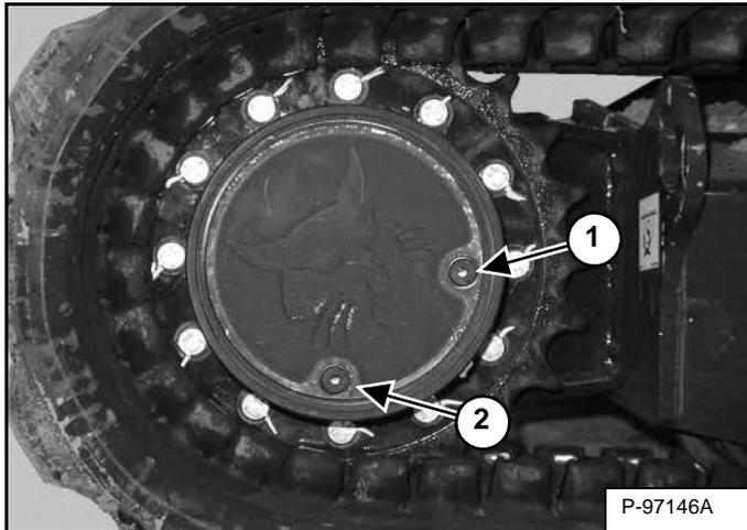
Поставьте экскаватор на ровную поверхность, чтобы заглушки (элементы 1 и 2) [Рис. 256] приняли указанное положение.
