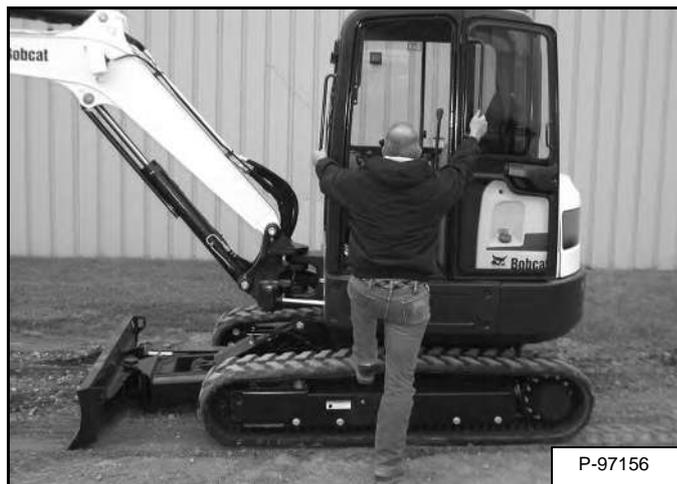
Используйте поручни и гусеницы, чтобы попасть под навес/в кабину [Рис. 79].
