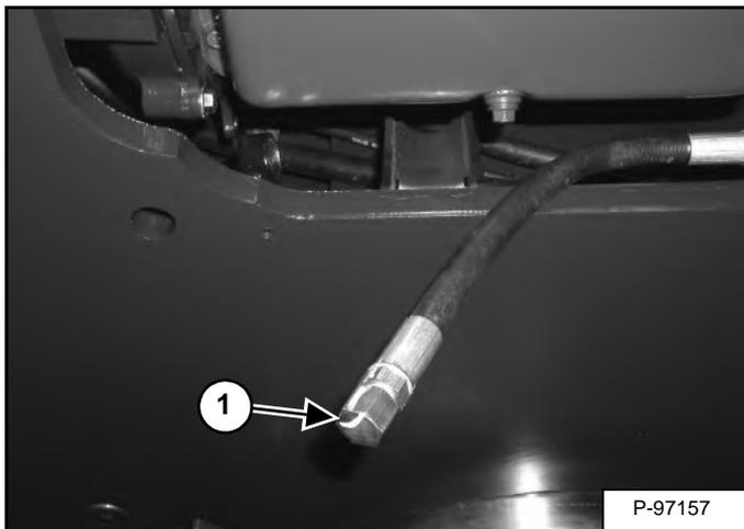
Поместите контейнер под экскаватором. Снимите пробку сливного отверстия (элемент 1) [Рис. 221] со сливного шланга.
