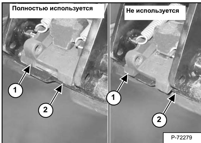
Визуально проверьте фиксатор быстрого соединения (элемент 1) в креплении ковша (элемент 2) [Рис. 113]. Фиксатор должен полностью использоваться.
