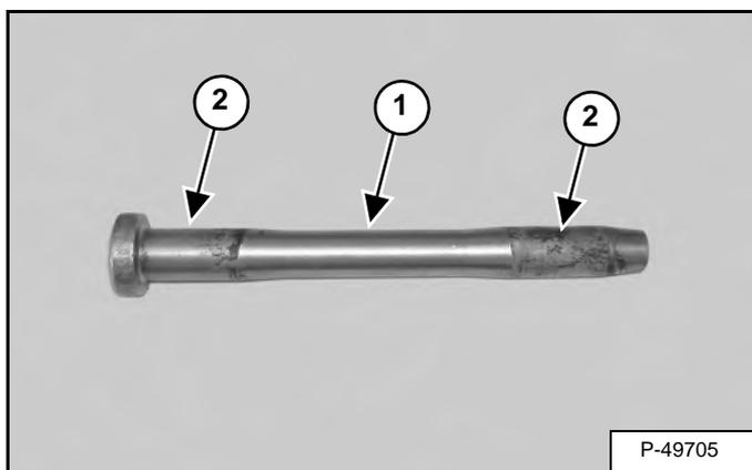
Проверьте штырь (элемент 1) [Рис. 143] на предмет износа или повреждения. При необходимости замените стержень.
