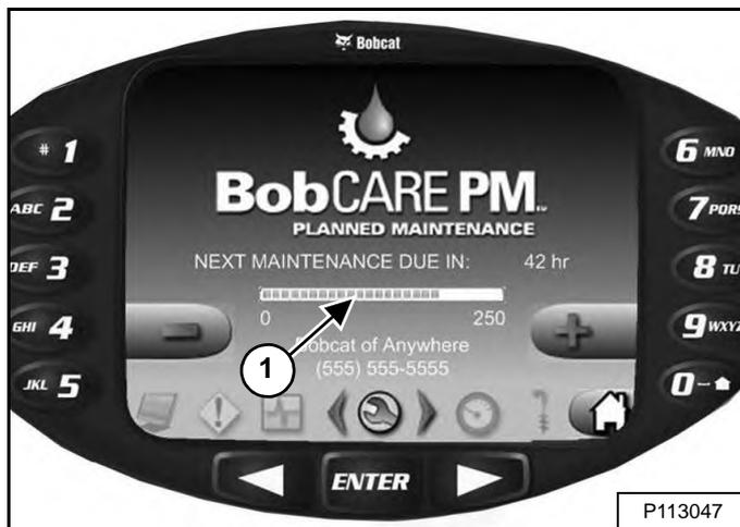
На приборной панели Deluxe (если имеется) будет отображаться окно сообщения (элемент 1) [Рис. 287] о времени, оставшемся до следующего обслуживания. Если техобслуживание не было произведено вовремя, будет высвечиваться окно красного цвета. Сообщение NEXT MAINTENANCE DUE (ВРЕМЯ СЛЕДУЮЩЕГО ТЕХОБСЛУЖИВАНИЯ) изменится на MAINTENANCE PAST DUE (ПРОСРОЧЕННОЕ ВРЕМЯ ТЕХОБСЛУЖИВАНИЯ), и будет отображаться количество просроченных часов.
