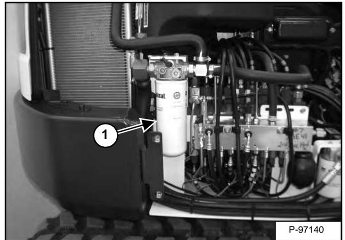
Снимите гидравлический фильтр (элемент 1) [Рис. 243].
