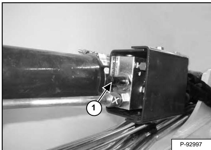
Снимите пластиковую защитную крышку (элемент 1) [Рис. 74] с клапана.
