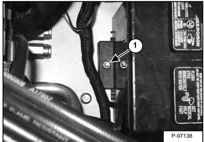
Отверните болт (элемент 1) [Рис. 238] и снимите прижим.
