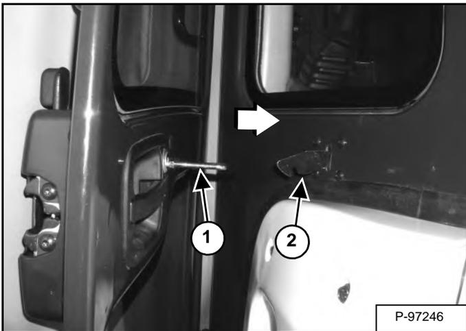
Откройте дверь достаточно широко, чтобы фиксирующая рамка (элемент 1) вошла в фиксатор (элемент 2) [Рис. 23], что позволит удерживать дверь в открытом положении.
