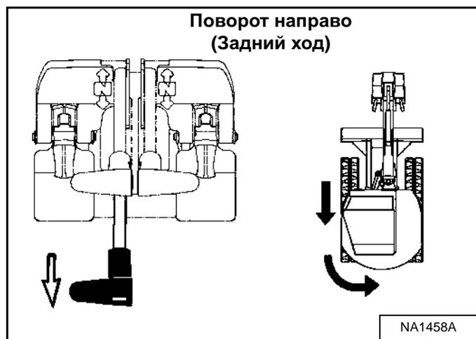
Чтобы повернуть направо при движении назад, передвиньте левый рычаг управления назад [Рис. 44].
