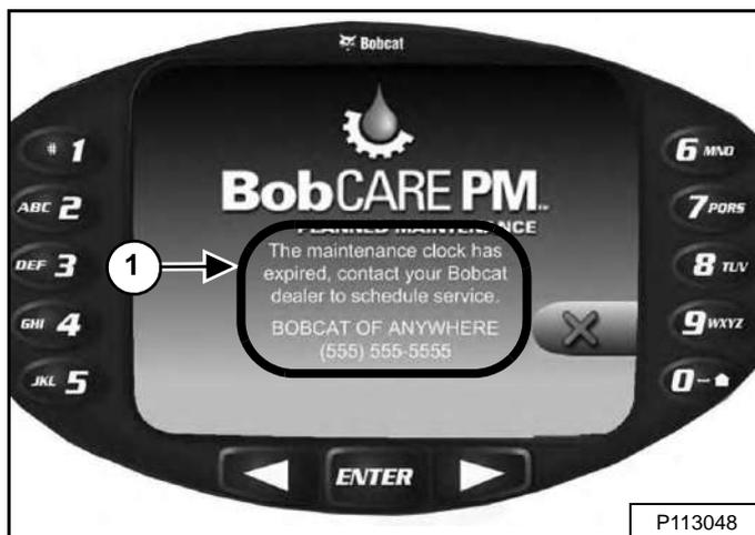
На приборной панели Deluxe (если имеется) будет отображаться сообщение (элемент 1) [Рис. 286] о необходимости проведения обслуживания машины.
