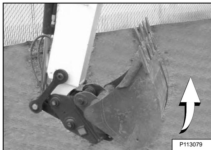
Полностью сложите устройство быстрого соединения [Рис. 135].
