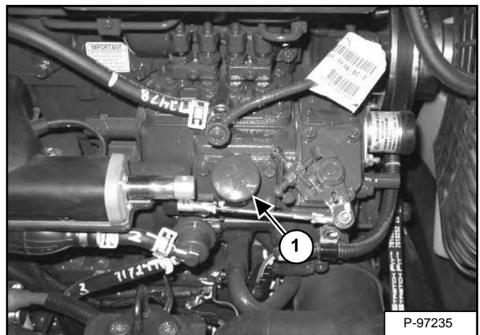
Снимите крышку (элемент 1) [Рис. 223].
