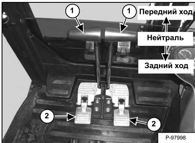
Сидя в кресле оператора, расположите отвал перед машиной. Плавно передвиньте оба рычага управления\* (элемент 1) [Рис. 42] вперед для движения вперед или назад для движения назад.
