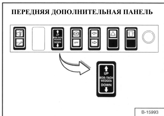
Нажмите и удерживайте переключатель BOB-TACH WEDGES DOWN (ОПУСКАНИЕ КЛИНЬЕВ) (Рис. Э-13) (передняя дополнительная панель управления) до тех пор, пока клинья полностью не пройдут в отверстия монтажной рамы и прочно не зафиксируются. Выключите двигатель и выйдите из погрузчика.
