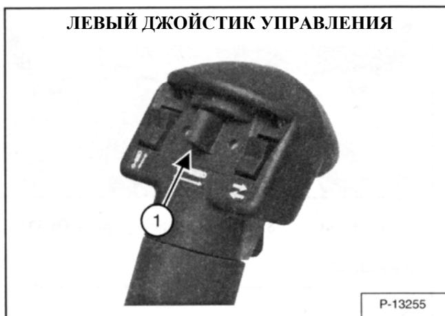
Надавите переключатель (поз.1, рис.Э-39) на левом джойстике вправо, чтобы **выдвинуть левую сторону отвала (поз.1, рис.Э-41) вперед.**
