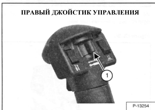
Надавите переключатель (поз.1, рис.Э-40) на правом джойстике влево, чтобы **выдвинуть правую сторону отвала (поз.2, рис.Э-41) вперед.**
