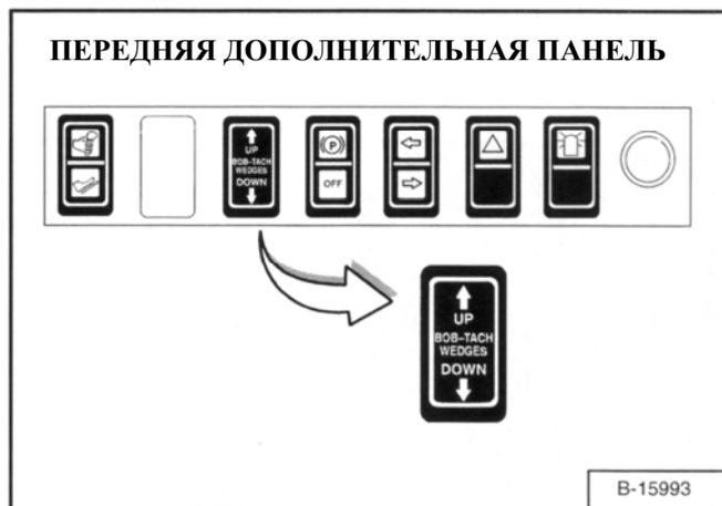
Нажмите и удерживайте переключатель *BOB-TACH WEDGES UP (ПОДЪЕМ КЛИНЬЕВ)* (Рис. ТО-68), пока клинья полностью не поднимутся. Нажмите и удерживайте переключатель *BOB-TACH WEDGES DOWN (ОПУСКАНИЕ КЛИНЬЕВ)* (Рис. ТО-68) пока клинья полностью не опустятся.
