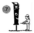
Осуществляйте смазку инструмента после каждых двух часов работы, используя только смазку на основе дисульфида молибдена. Если имеется смазочная станция, убедитесь, что её резервуар наполнен и насос находится в работоспособном состоянии.
