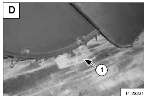
Для защиты дна трейлера от режущих зубьев, при погрузке дисковой фрезы в трейлер поместите режущее колесо на кусок дерева (позиция 1) [D].
