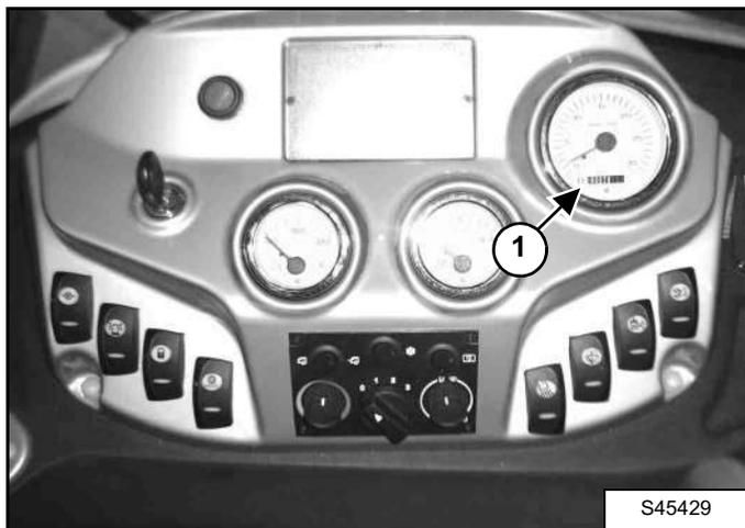
Работы по техобслуживанию планируются по счетчику моточасов (1). Для соблюдения межсервисных интервалов и обеспечения эффективной эксплуатации машины необходимо следить за счетчиком моточасов. Регулярно выполняйте все работы по техобслуживанию, пользуясь руководством по эксплуатации и обслуживанию.
