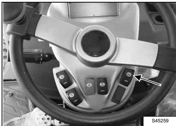
При движении по мягкому грунту, грязи и на скользких участках блокировка дифференциала обеспечивает равномерное распределение крутящего момента между задними колесами.
