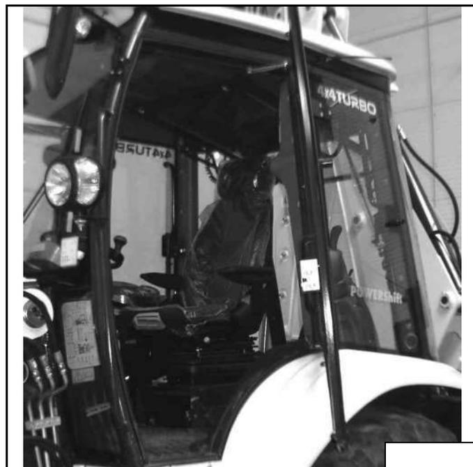
Для вентиляции кабины дверь может быть открыта частично.
