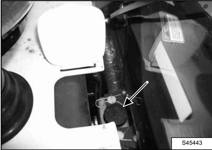
Уровень тормозной жидкости следует проверять, когда машина стоит на ровной площадке. Бак тормозной жидкости расположен справа от джойстика управления погрузочным оборудованием.
