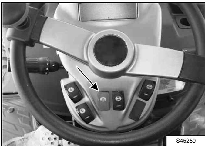
Применяется при кратковременной остановке или при возникновении неисправности. При нажатии выключателя начинают мигать указатели поворота и включается подсветка выключателя.
