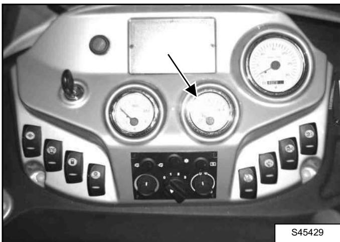
Перед началом работы проверьте указатель уровня топлива на боковой панели управления.
