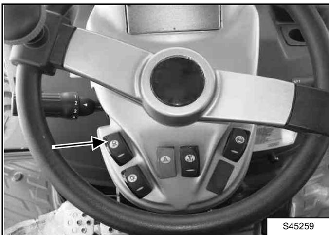
Переднее рабочее освещение применяется при работе в темное время суток или в плохо освещенных местах. При нажатии выключателя загораются фонари освещения и включается подсветка выключателя.
