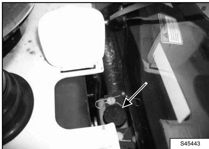
Долейте масло через заливную горловину. Установите на место сливную пробку и крышку заливной горловины. Прокатайте систему.
