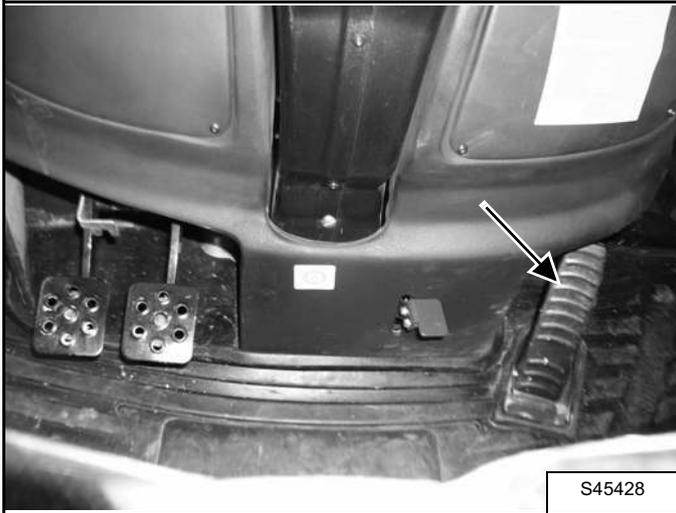
Расположена под рулевой колонкой. Применяется во время движения и при работе с органами управления погрузочным навесным оборудованием. При нажатии педали скорость движения машины увеличивается, а при отпускании уменьшается.
