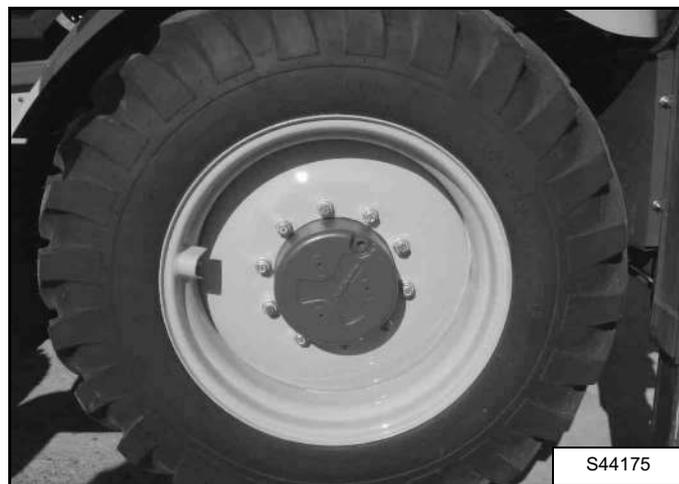
Проверьте моменты затяжки колесных гаек.
