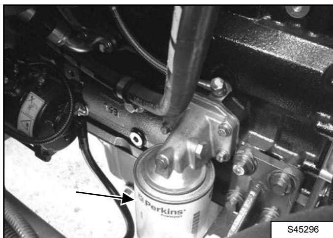
Снимите патрон фильтра, используя гаечный ключ для фильтра. Очистите уплотняемую поверхность на опоре фильтра. Смазав уплотняемую поверхность нового фильтра, вставьте его в корпус.
