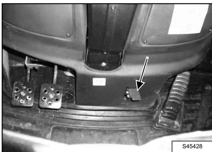
Расположена под рулевым колесом. Предназначена для наклона рулевой колонки вперед и назад с целью получения удобного положения для оператора.
