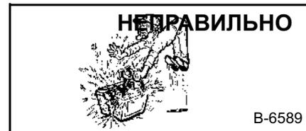
⚠ Свинцово-кислотные аккумуляторы выделяют пожаро- и взрывоопасные газы.
