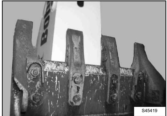
Регулярно проверяйте зубья ковша на предмет износа. Когда зубья ковша изнашиваются, при копании затрачивается большей усилий. Не работайте с ковшом, у которого отсутствуют зубья.
