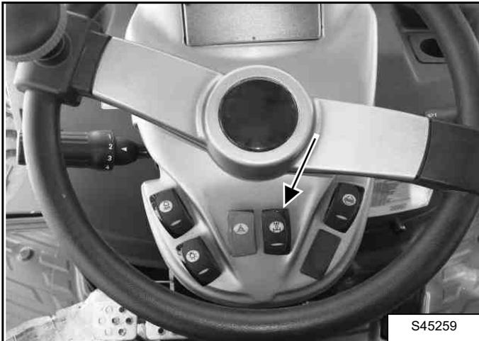
В состоянии перед нажатием данного выключателя включен только задний мост. После его нажатия включается также передний ведущий мост. При этом на панели управления загорается соответствующий индикатор.
