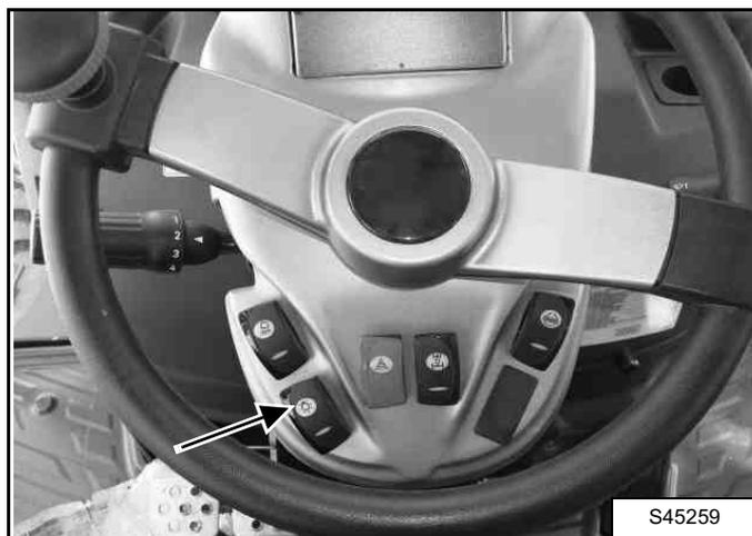
При нажатии выключателя загораются стояночные фонари. При повторном нажатии выключателя включается ближний или дальний свет — в зависимости от положения переключателя света фар. При нажатии главного переключателя света включается его подсветка. Когда включается дальний свет, загорается сигнализатор на передней панели управления.
