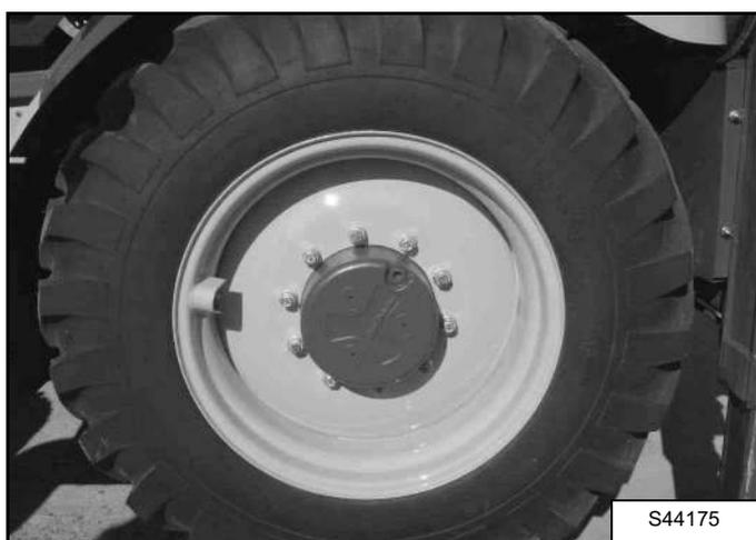
Проверьте состояние шин и давление в них. При необходимости замените.
