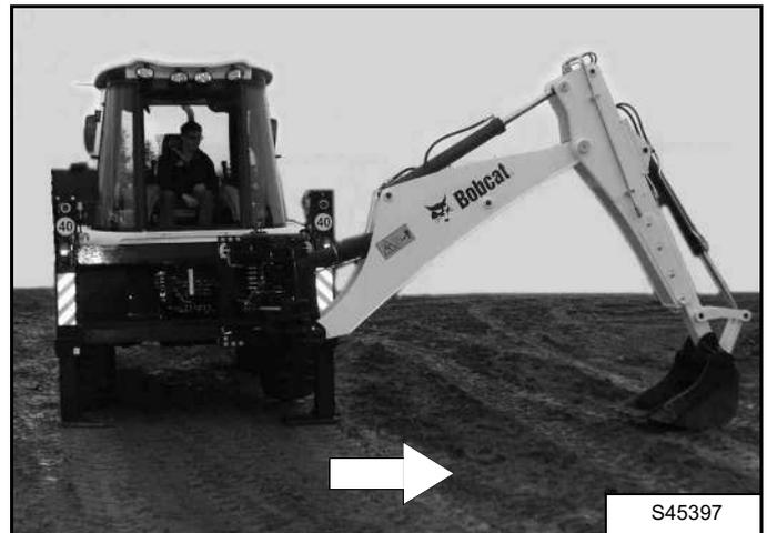
Используя рукоятки управления экскаваторным оборудованием для позиционирования рукояти, стрелы и ковша, установите ковш на землю (см. рисунок).
