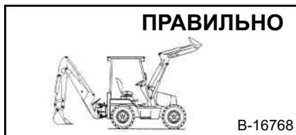
⚠ При обслуживании погрузчика с поднятой стрелой всегда используйте допущенный к эксплуатации упор стрелы. При повреждении упора стрелы замените его.
