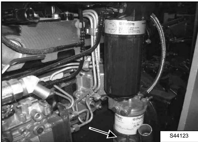
Отверните пробку на водоотделителе топливного фильтра и слейте конденсат, пока не начнет сливаться топливо, затем затяните пробку.
