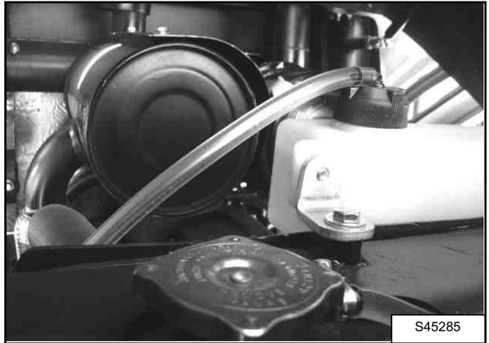
Чтобы проверить уровень охлаждающей жидкости в двигателе, поставьте машину на твердой ровной площадке. Поднимите погрузочное навесное оборудование, установите допущенный к эксплуатации упор стрелы и включите стояночный тормоз. Выключите двигатель. Выньте ключ из замка зажигания.
