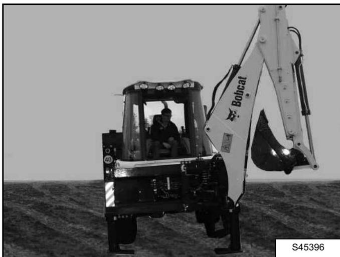
Для сдвига находящегося слева экскаваторного оборудования вправо опустите левую стабилизирующую опору так, чтобы левое заднее колесо приподнялось над землей. Опустите правую стабилизирующую опору на землю (см. рисунок).
