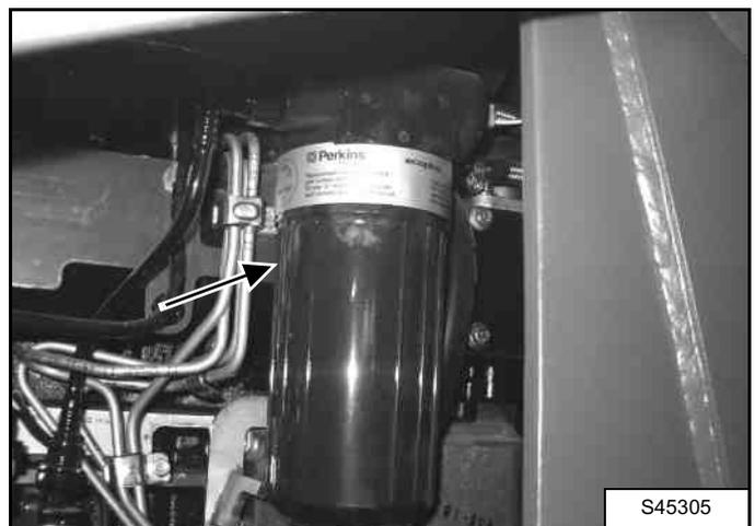
Снимите патроны топливного фильтра. Смазав уплотнения новых патронов топливного фильтра тонким слоем масла, установите патроны на место. После этого удалите воздух из топливной системы.
