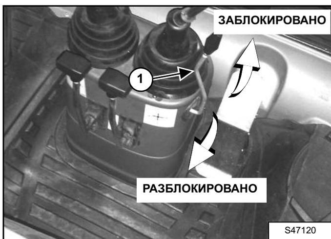
Для блокирования джойстиков управления экскаваторным оборудованием потяните рычаг (1) вверх и поверните вверх так, чтобы он до конца поднялся. Джойстики заблокируются.
